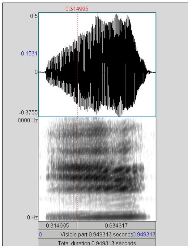
Figura 3. Esempio di associazione tra oscillogramma (sopra) e spettrogramma (sotto) per la stessa produzione analizzata in Fig. 1.
