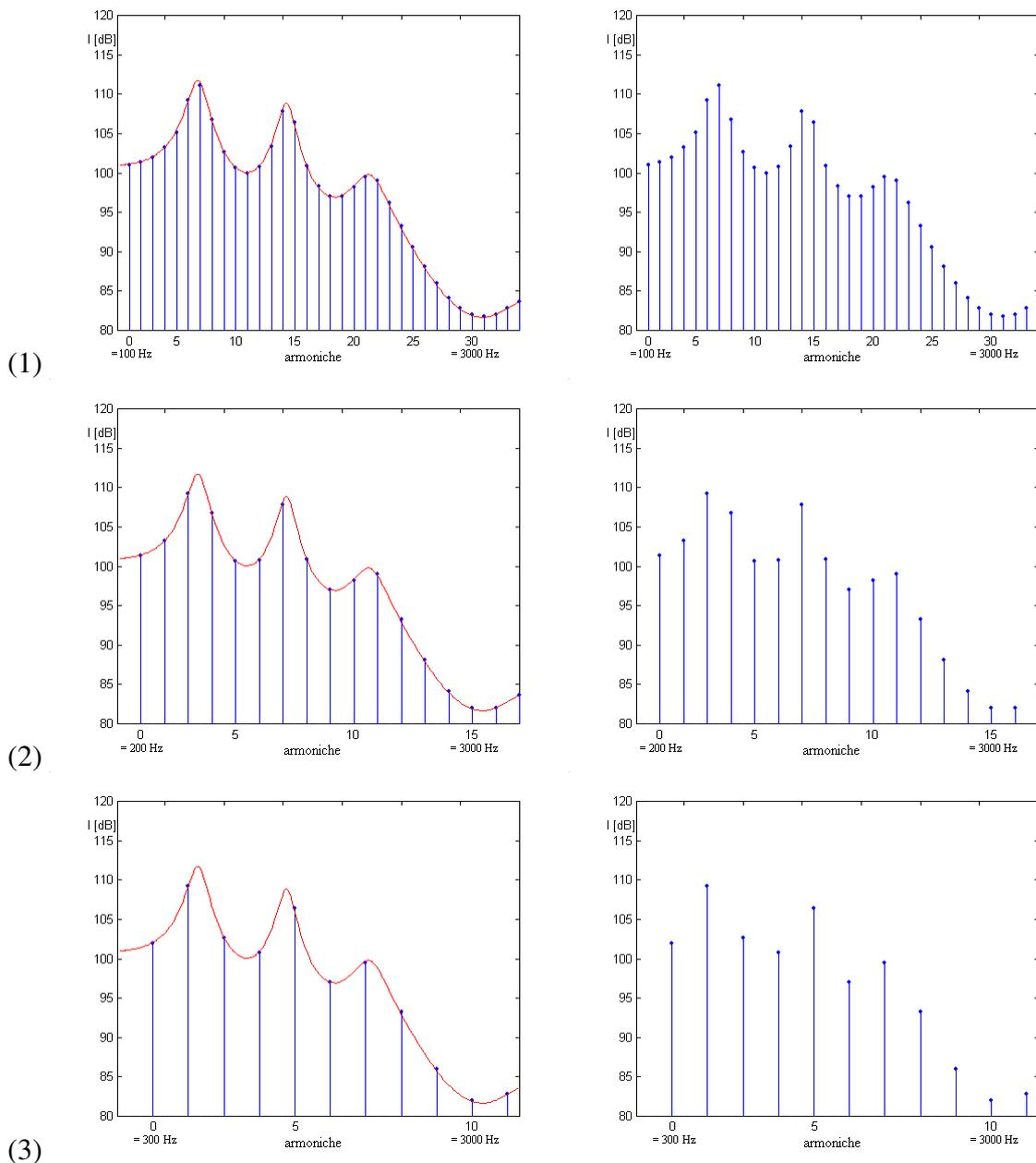
Figura 12. Spettri ideali con (a sinistra) e senza (a destra) l'indicazione del profilo della funzione di trasferimento del filtro vocale. Dall'alto in basso: (1) voce ideale a bassa  $f_0$  ( $M$ ); (2) voce ideale a media  $f_0$  ( $F$ ); (3) voce ideale ad alta  $f_0$  ( $B$ ) [grafici ottenuti con Matlab©].
