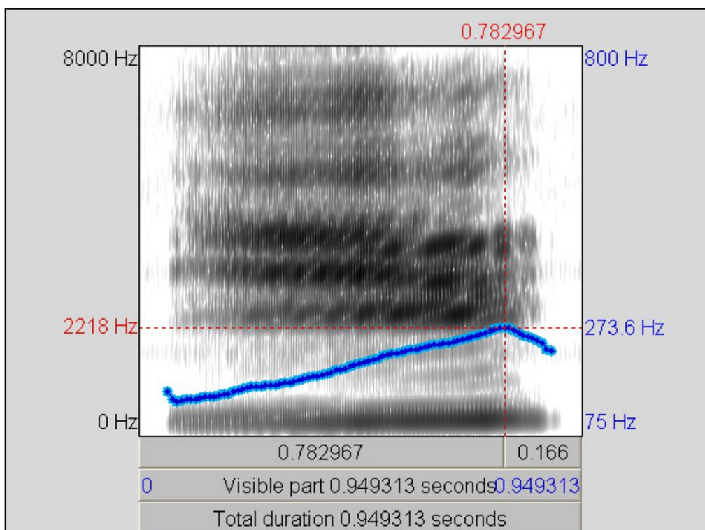
Figura 4. Esempio di profilo melodico sovrapposto allo spettrogramma della stessa produzione analizzata in Fig. 1. Il picco massimo segnalato a circa 274 Hz corrisponde al valore calcolato in Fig. 2 in base alla misura della frequenza della nona armonica (si noti che il minimo iniziale di  $f_0$  è pari in quest'esempio a 137 Hz, esattamente coincidente con la metà del valore massimo: il locutore ha realizzato quindi in questa sillaba un *glissando* ascendente di un'ottava).
