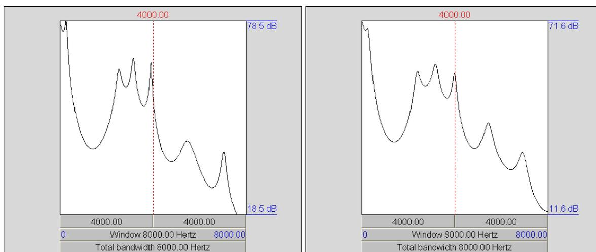
Figura 10. Esempi di analisi *LPC* del suono vocalico [i] della produzione analizzata in Fig. 1. A sinistra un profilo ottenuto con un'analisi condotta in una finestra di segnale di circa 100 ms e a destra uno ottenuto a partire da una finestra di 10 ms: le formanti emergono in entrambi i casi con definizione simile.
