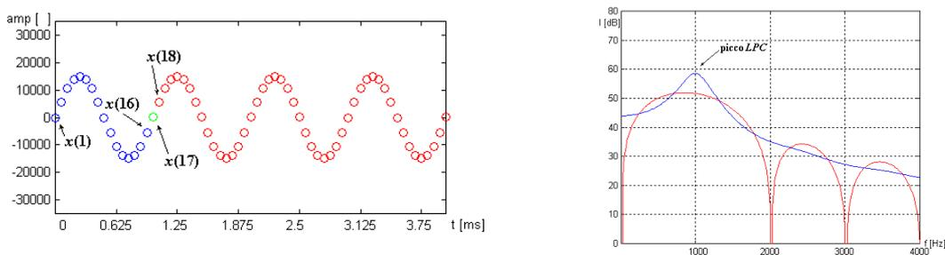
Figura 9. A sinistra, campioni del tono puro di fig. 8 coinvolti nella predizione *LPC* del 17° campione (evidenziati in blu e verde). A destra, profilo del (la funzione di trasferimento) del filtro *LPC* e curva dello spettro *FFT* ottenuti sullo stesso numero di punti (i 16 campioni usati per la predizione). Si noti come in questo caso la stima *LPC* (il picco) dia migliori risultati, determinando un profilo che individua la principale componente frequenziale [grafici ottenuti con Matlab®].
